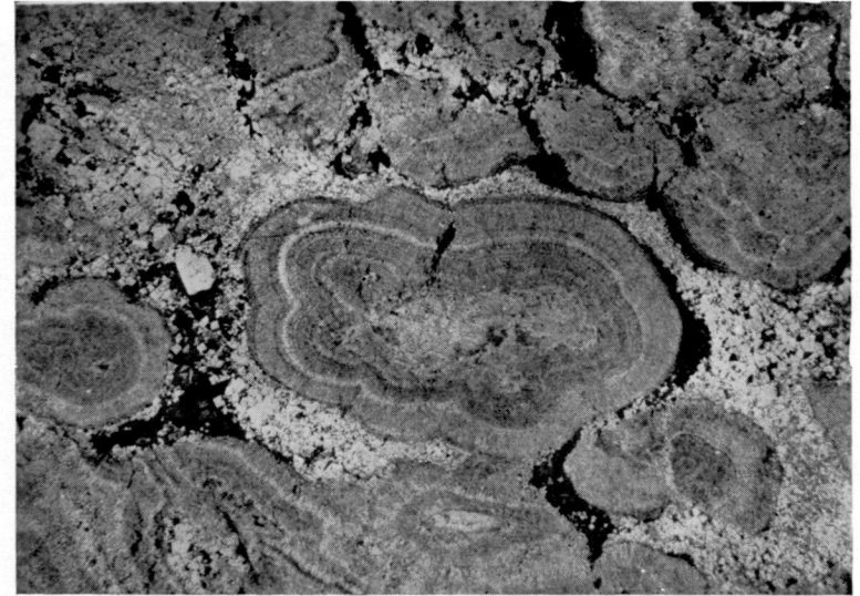
Microfoto 25.—Muestra pulida 639×60. Luz reflejada natural. Ataque electroquímico. Pirita coloreada arrionada con recrecimiento de calcopirita y idiomórfica con estéril en el relleno.
